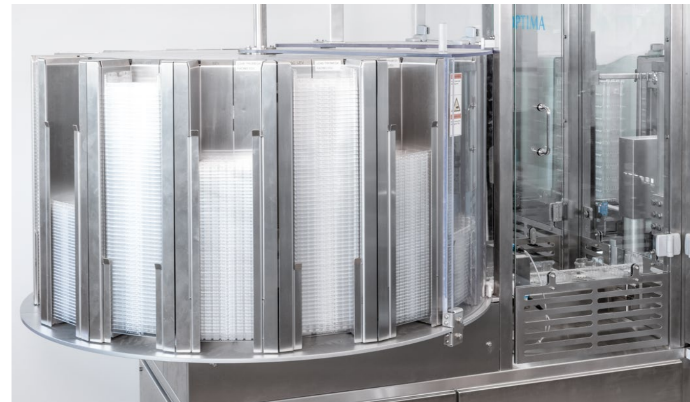
↑ Im großen Traymagazin ist Platz für unterschiedliche Trayformate.
