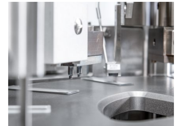
↑ Nach der Vorversiegelung steht genügend Zeit zur Verfügung, um die finale Heißversiegelung mit hoher Leistung durchführen zu können.
