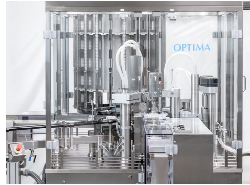
← Teil der Aktualisierungen der ersten Maschinenversion war ein neues Behältnismagazin. Mit diesem lassen sich die Anlagen jetzt unterbrechungsfrei betreiben.
