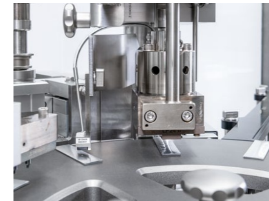
↑ An vier Punkten wird vorversiegelt, anschließend komplett verschweißt. Die Siegfolie wird zu 100 Prozent verwendet, sodass kein Abfall entsteht.
